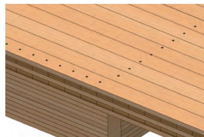
CLT 床 - 集成材梁接合
