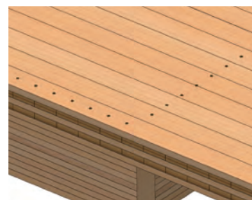
CLT 床 - 集成材梁接合
