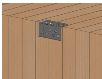
CLT 壁 - 床（屋根）接合
